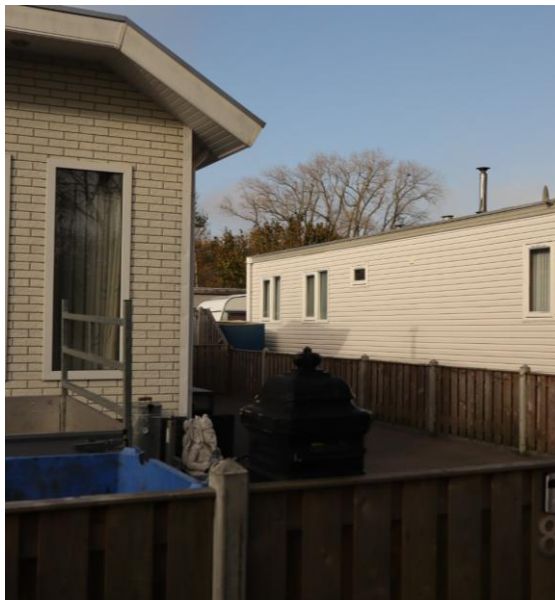
▲ 2,5 meter afstand tussen de woonwagens en de perceelgrens vanwege brandveiligheid
